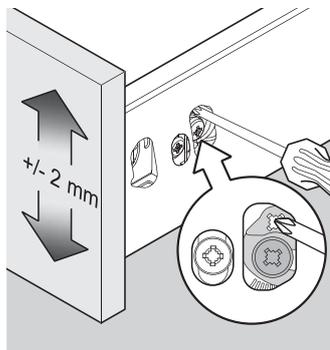
Отрегулировать положение фасадного профиля и снова затянуть зажимные винты.
