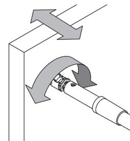
Регулировка наклона фасада с круглым рейлингом производится вращением винтовой втулки.
