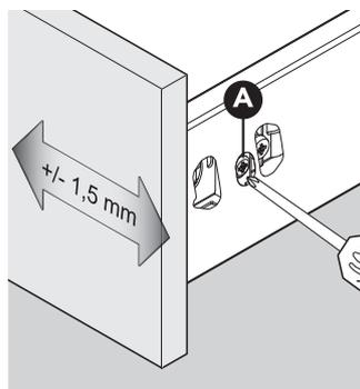
Повернуть регулировочный винт (А). Теперь переместить правую боковину с помощью встроенной регулировки по горизонтали.
